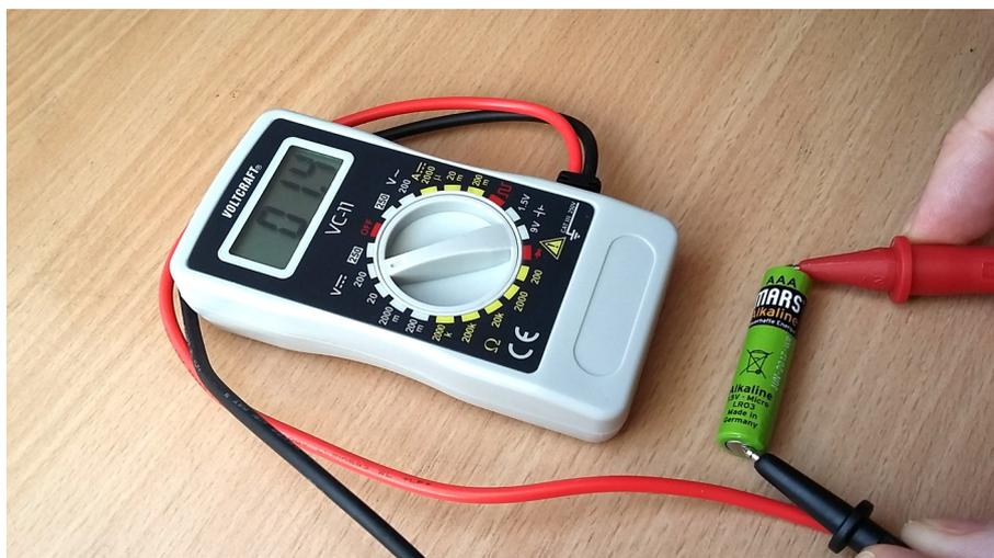
Abbildung 8: Messung der Spannung einer Batterie
