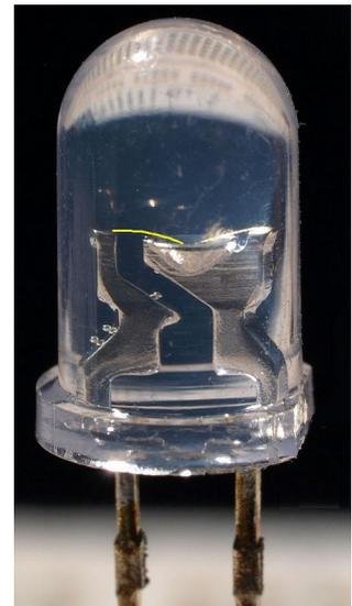
Abbildung 5: Blick ins Innere einer LED
